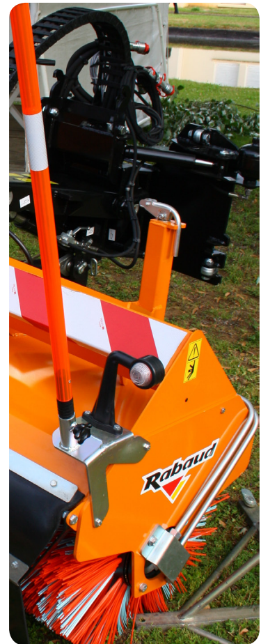
Figure n° 2 : Outil de balayage avec système de fixation (droits SEMR)
