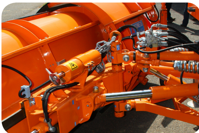
Figure n°6 : Connexions hydrauliques (droits SEMR)
